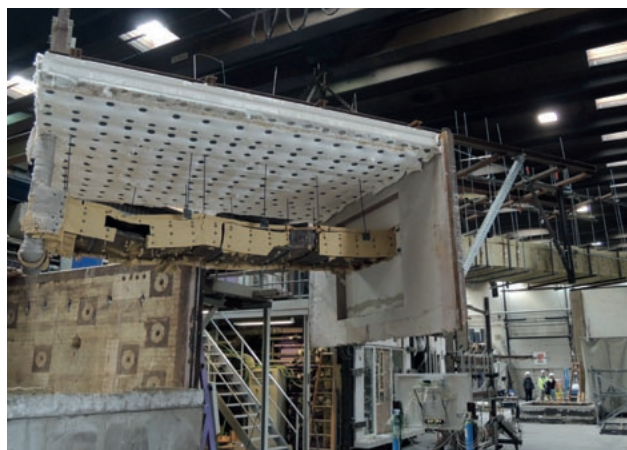
Obr. 73 Pohled na potrubí typu C po 120 minutách působení normového požáru
