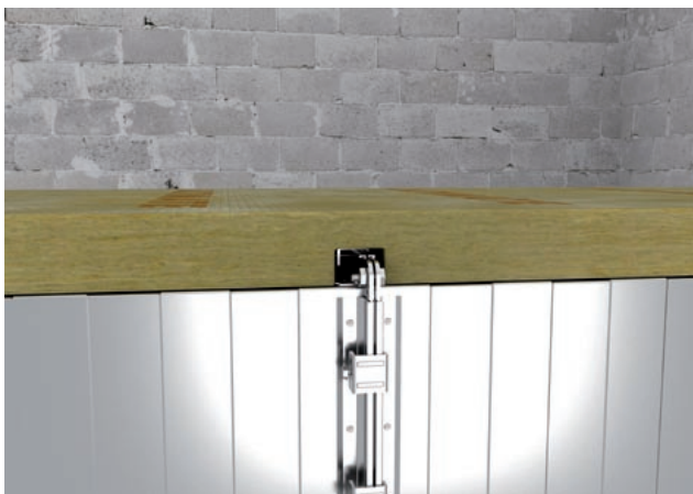
Obr. 69 Je-li použita izolační deska o tloušťce izolace > 50 mm, není nutno v místě příruby navyšovat tloušťku izolace a postačuje jednovrstvé kladení s lokálním zeslabením izolace v místě příruby
