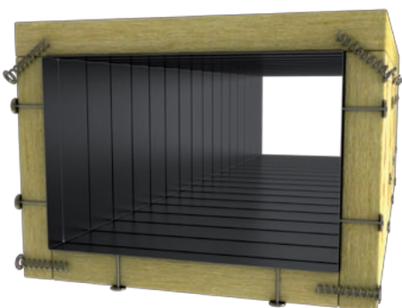
Obr. 36 Horní deska překrývá boční desky, které překrývají spodní desku
