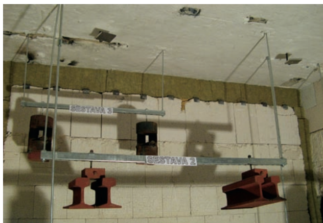
Obr. 13 Pohled na atestované závěsné zařízení před zkouškou v peci
