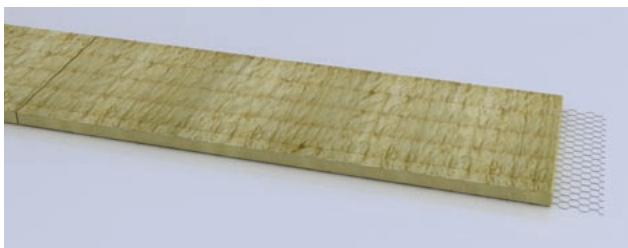
Obr. 53 Přesah pletiva 100 mm je nutný kvůli podélnému spojení rohože
