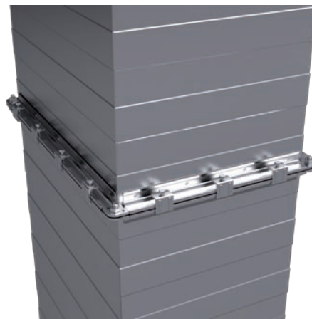
Obr. 33 Příruby zajištěny stahovacími svorkami
