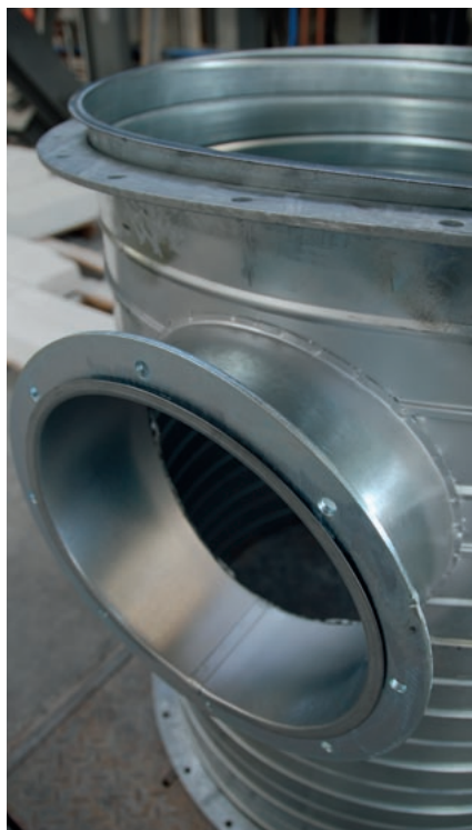
Obr. 26 Pohled na spiro potrubí spojené přírubami před montáží
