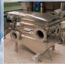
SFT filtr - separace nerozpuštěných látek
