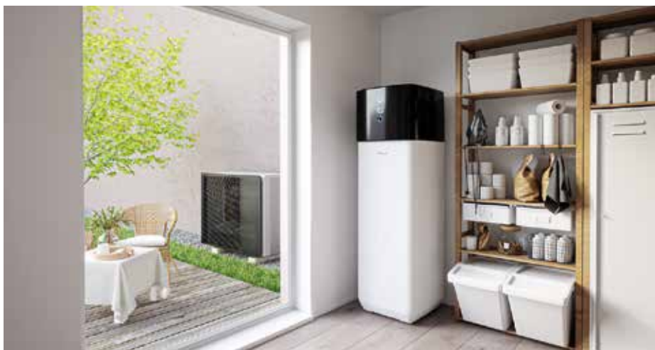
Altherma 3 H HT je „hydro split“ a propojení mezi vnitřní a venkovní jednotkou pomocí vodního potrubí může instalovat i řemeslník topenář, tzn. bez certifikátu na F-plyny; současně ale musí realizovat ochranu před poškozením mrazem. Všechny ostatní parametry jako topný výkon, příkon, účinnost, hluk atd. jsou víceméně totožné jako u „chladičového splitu“ Altherma 3 R MT (poznámka redakce – obrázek nemá přímou souvislost se shora publikovanou studií) Autor: Daikin
