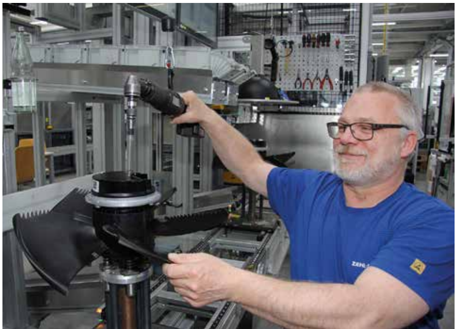
Vysoká poptávka podněcuje výrobu ventilátorů pro tepelná čerpadla: Markus Weiser montuje v závodě Kupferzell axiální ventilátor s EC motorem
