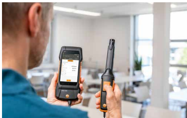
Obr. 2 Meranie parametrov kvality vzduchu v budove
