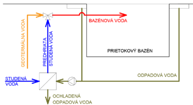
Obr. 3 Schéma prietokového bazéna s jedноступňovým systémom spätného získavania tepla
