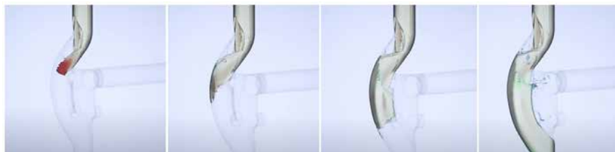
Obr. 5 Simulácia vírivého charakteru prúdenia vody v tvarovke Sovent [8]
