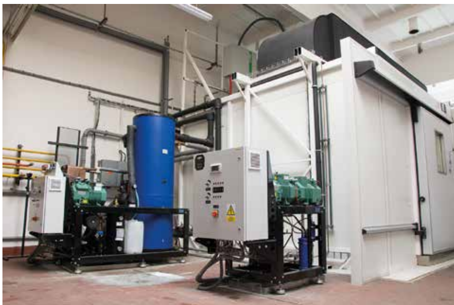
Obr. 1: Klimatická komora pro zkoušky TČ vzduch/voda
