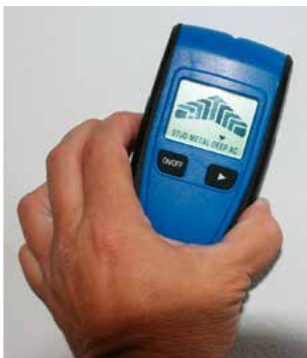
Obr. 5: Polohu svislých nosných trámů jsem přibližně odhadl s pomocí jednoduchého přístroje na hledání odlišných materiálů ve stěnách.
