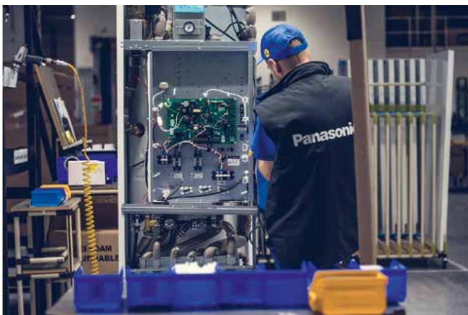
Montážní linka na výrobu vnitřních jednotek tepelných čerpadel typu vzduch-voda značky Panasonic Aquarea v provedení All in One generace J
