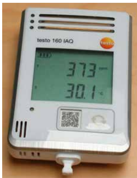
Obr. 1: Pro ověření potřebnosti větrání jsem použil výrobek firmy Testo. Při okení koncentraci \text{CO}_2 okolo 370 ppm se v nevětrané ložnici po ránu pohybovala koncentrace \text{CO}_2 na úrovni až 3000 ppm.
