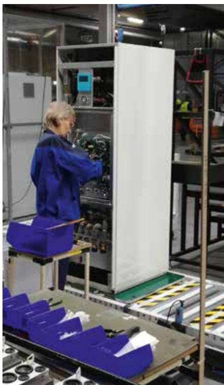
Montážní linka na výrobu vnitřních jednotek tepelných čerpadel typu vzduch-voda značky Panasonic Aquarea v provedení All in One generace J
