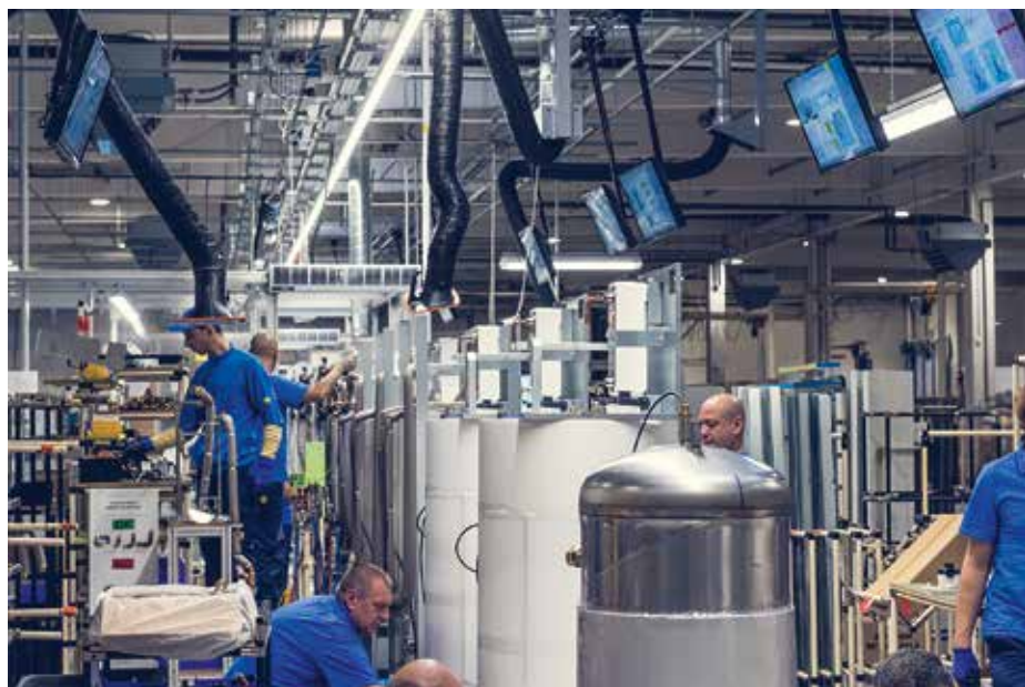
Montážní linka na výrobu vnitřních jednotek tepelných čerpadel typu vzduch-voda značky Panasonic Aquarea v provedení All in One generace J (s chladivem R32 – podle hrdel pro přívod chladiva umístěných nahoře)
