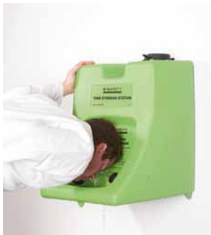
Tanková přenosná sprcha 60 l na stůl nebo na stěnu, pro výplach 15 minut. Výplach: gravitační, bez tlaku
