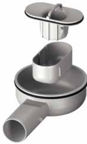
Sanační model pro vestavné výšky od 70 mm, odtokový výkon: 0,4-0,45 l/s, výška vodní uzávěry: 25 mm (Foto: Viega)
