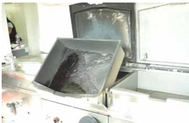
Obr. 2 Celkový pohled na vykloněnou pánve, na dně pánve jsou patrné zbytky po spáleném oleji
