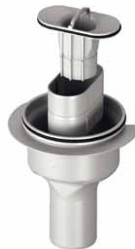
Model se svislým základním tělesem pro vestavné výšky od 40 mm, odtokový výkon: 0,9-1,1 l/s, výška vodní uzávěry: 50 mm (s možností použití protipožární průchodky) (Foto: Viega)
