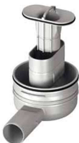
Odtok pro vestavné výšky od 95 mm, odtokový výkon: 0,5-0,55 l/s, výška vodní uzávěry: 50 mm ( lze zkrátit na výšku sanačního modelu) (Foto: Viega)
