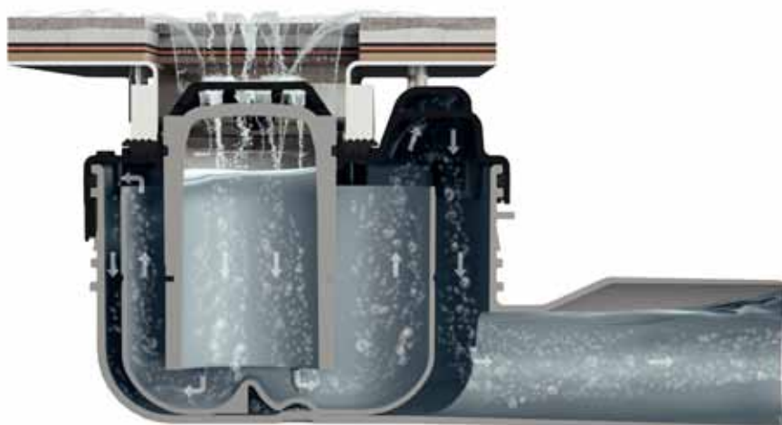
Patentovaná konstrukce umožňuje zvláště nízkou vestavnou výšku, při současně vysokém odtokovém výkonu a spolehlivé ochraně před obtěžujícími zápachy z kanalizace (Foto: Viega)
