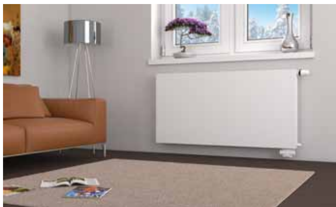
Obr. 1 Při sériovém řazení desek protéká otopná voda nejdříve čelní deskou a následně deskou zadní; vlivem sálání z čelní desky, různých podílů přestupu tepla konvencí z jednotlivých stran desek radiátoru při totožném průtoku otopné vody oběma deskami se teplotní spád na deskách nedělí přesně na polovinu
