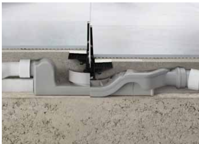
Doplňující model sprchového žlábkového Advantix Vario (vpravo) potřebuje výrazně menší stavební výšku než standardní model. Byl konstruován speciálně pro sanaci a dokáže si poradit i s nevýhodnými možnostmi připojení odtoku: odtok a odtokové koleno lze otočit o 360°. (Foto: Viega)
