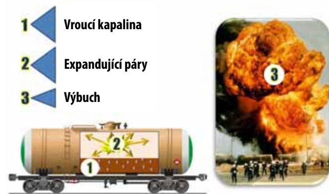
Výbuch expandujících par vroucí kapaliny (BLEVE – Boiling Liquid Expanding Vapour Explosion)
