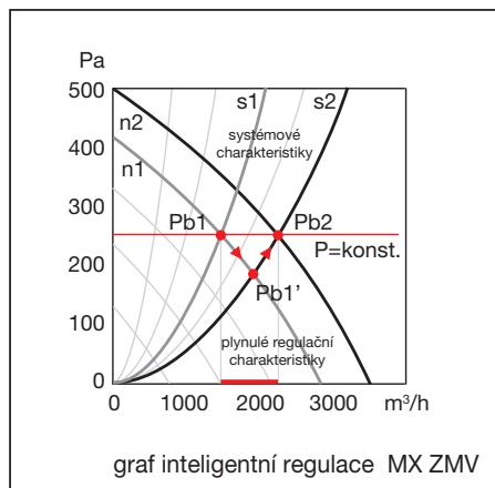
Šípky ukazují změnu pracovního bodu z Pb1 na Pb2 a zároveň výkonové charakteristiky ventilátoru z otáček n1 na n2 při změně systémové charakteristiky z s1 na s2, při použití regulace na konstantní tlak ve stoupacím potrubí.
