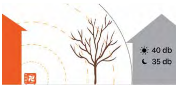
Tepelné čerpadlo by mělo být umístěno tak, aby jeho hladina akustického tlaku nepřesahovala povolenou hodnotu 35 dB(A) v noci a 40 dB(A) ve dne v chráněném prostoru.
