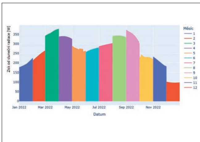
Obr. 4. Příklad výstupu – graf simulovaných hodnot tepelných zisků fasády od sluneční radiace v průběhu roku – software FSVM.
