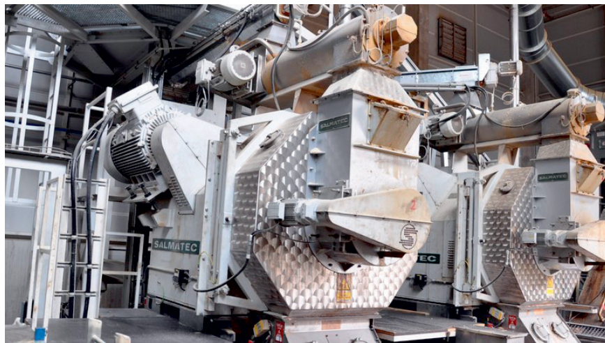
Dva peletovací lisy ve velkovýrobě dřevních pelet
