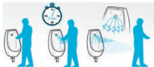
Infračervený senzor detekuje od uživatele odražené světlo.
