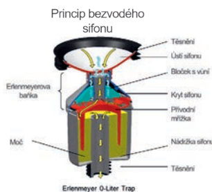
Princip Erlenmeyerovy baňky používaný u bezvodých urinálů LAUFEN. Minimálně jednou denně by se měl urinál opláchnout a sifon prolít čistou vodou.
