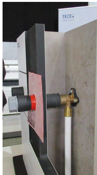
Obr. 3 Boční pohled, který ukazuje těsnost navlečení vulkanizované manžety na těsnicí pouzdro
