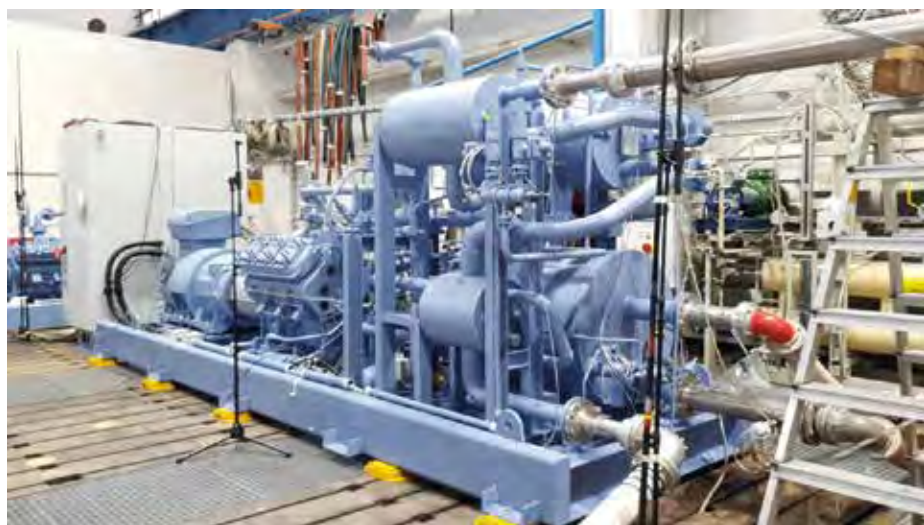
Tepelné čerpadlo RedGenium ve spojení se zbrusu novým pístovým kompresorem GEA Grasso V XHP umožňuje dodávat vodu teplou až +95 °C (Foto: GEA)
