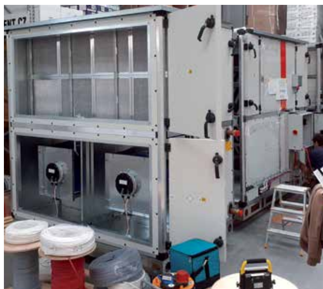
Montáž jednotiek DUOVENT® MODULAR vo výrobnom závode ELEKTRODESIGN ventilátory, s. r. o.
