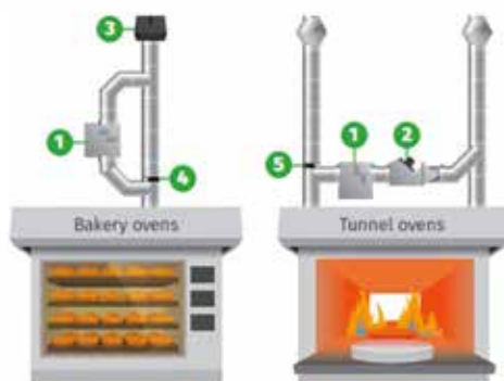
Obr. 3 Systém Exodraft možno inštalovať vertikálne aj horizontálne, pričom odolá teplotám až 600 °C.
