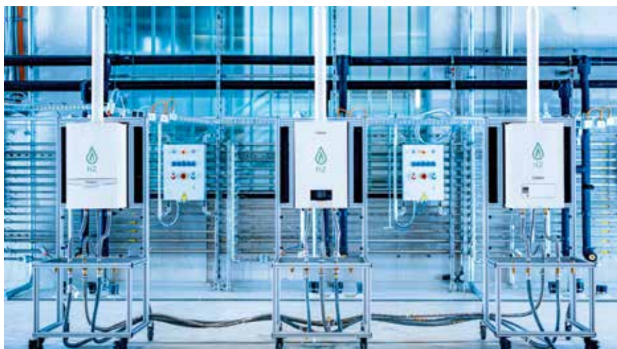
Vodíkové kotly budú vyzerať rovnako ako dnešné závesné kondenzačné kotly na zemný plyn.
