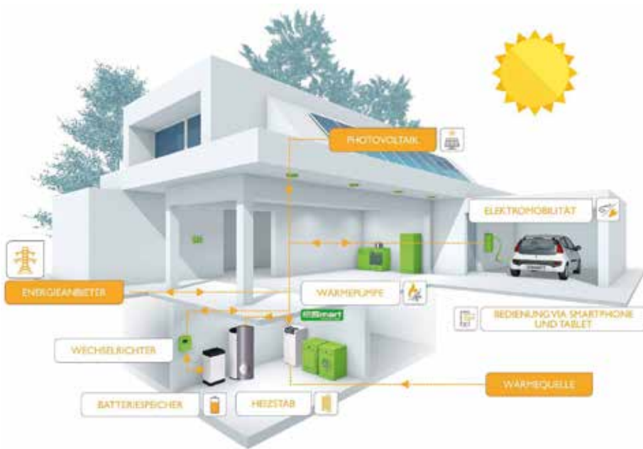
Pomocí systému E-smart pro správu energie lze řídit veškeré generátory (výrobníky energie) a spotřebiče v obytných a komerčních budovách
