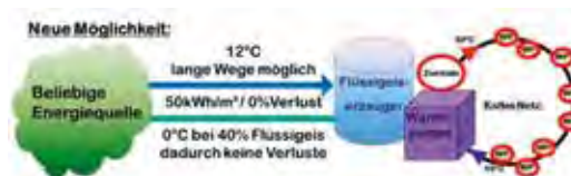
Obr. 7 Legenda: Neue Möglichkeit / Nová možnost Beliebige Energiequelle / libovolný zdroj energie 12 °C – lange Wege möglich / 12 °C – možné jsou velké transportní vzdálenosti 50 kWh/m 3 / 0% Verlust / 50 kWh/m 3 / ztráta 0% 0 °C bei 40% Flüssigeis / teplota 0 °C při 40% tekutém ledu dadurch keine Verluste / proto žádné ztráty Flüssigeiserzeuger / výrobnik tekutého ledu Wärmepumpe / tepelné čerpadlo kalttes Netz / síť rozvodu nízkoteplotní energie (30 °C/10 °C) WP / jednotlivá tepelná čerpadla napojená na síť, temperovanou centrálním tepelným čerpadlem – představuje zdroj tepla pro připojená tepelná čerpadla
