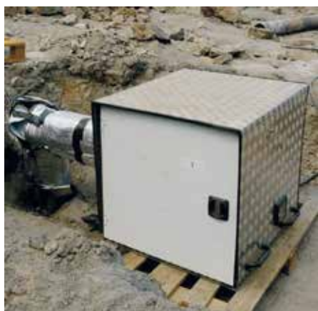
Měřicí aparatura pro polní zkoušku tepelné vodivosti hornin – Thermal Response Test (Obr. 1)
