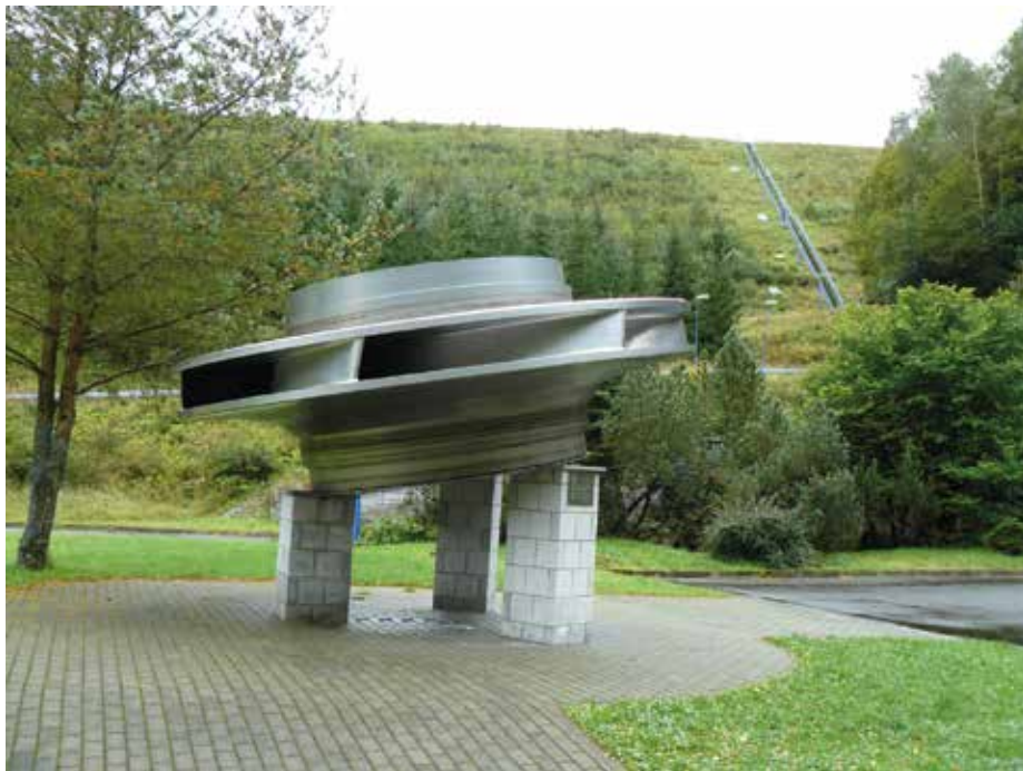
Původní oběžné kolo reverzní Francisovy turbíny FR 100 z roku 1996 uyměněné po cca 19 letech provozu Foto Václav Nosek
