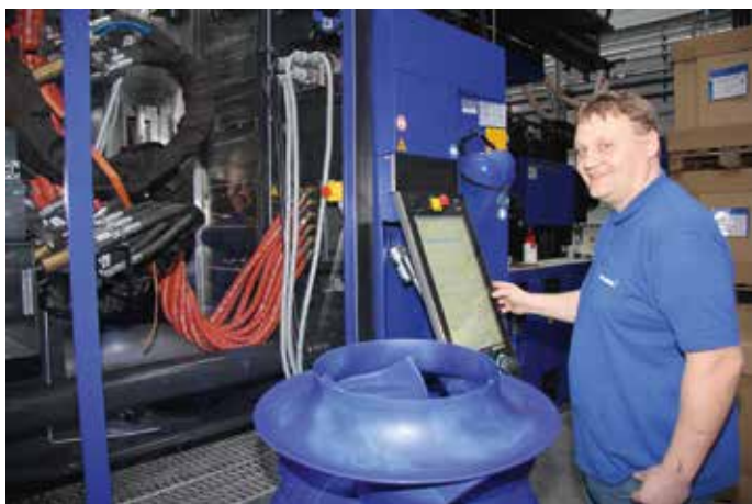
Ziehl-Abegg používá vysoce sofistikované nástroje, jejichž pořizovací hodnota je více než půl milionu Eur, na výrobu bionicky optimalizovaných ventilátorů (bionisch optimierte Ventilatoren) ze speciálního syntetického materiálu (plastu) ZAmid (Stefan Roeger), Foto Ziehl-Abegg / Rainer Grill
