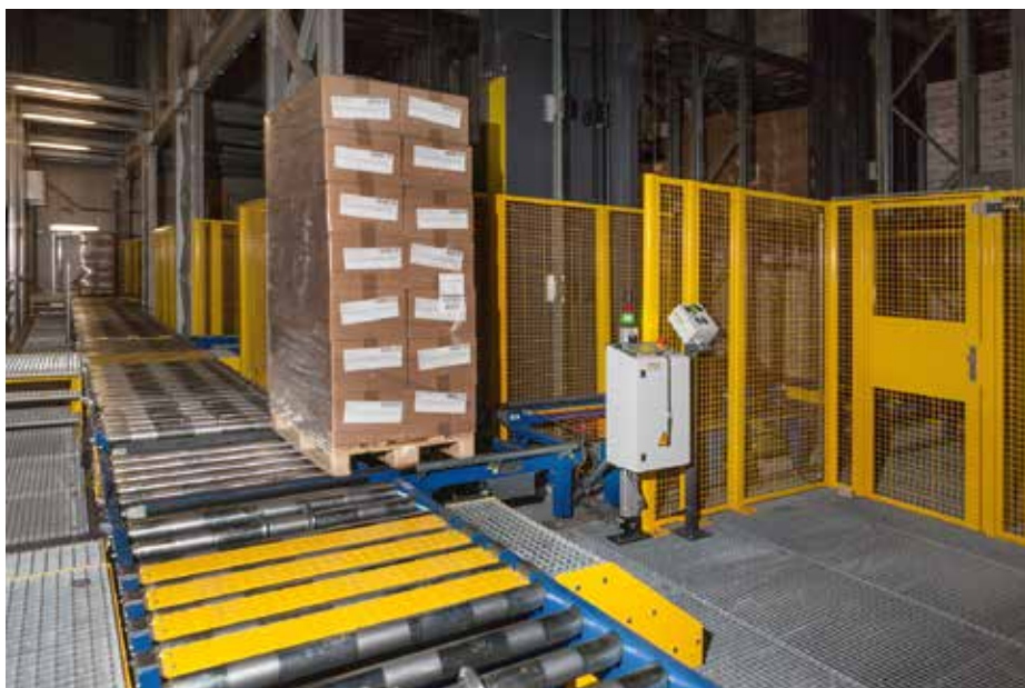
Z důvodů protipožární ochrany (aus Brandschutzgründen) je ve skladu, který je bez lidské obsluhy (im mannslosen Lager), redukováno obsah kyslíku na 15% / Foto Güntner (Gt_TK_Backwaren_180)
