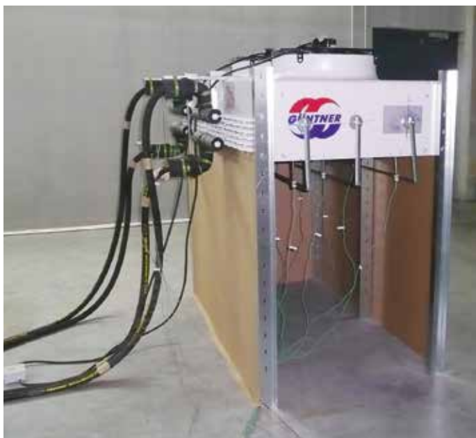
Obr. 4: Pohled na uspořádání měření na zkušební pro stanovení dodatečné tlakové ztráty na straně vzduchu, způsobené různě velkými nátokovými plochami (Abb4_Messaufbau_P1110898_bearbeitet.jpg)
