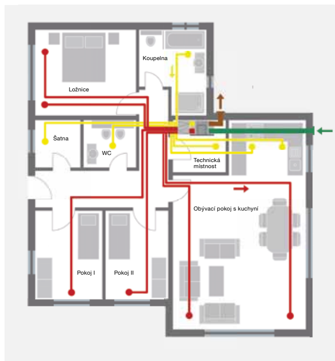
Obr. 2 Půdorys s vedením rozvodů vzduchu
