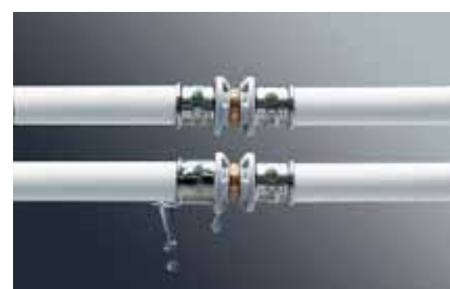
Optimální bezpečnost instalací: prvek SC-Contur zajišťuje snadné odhalení případných omylů nezalisovaných spojek při tlakové zkoušce rozvodů – jde o výrazný kvalitativní element všech systémů lisovaných spojek firmy Viega – zde pro potrubní systém „Sanfix Fosta“ (Foto: Viega)
