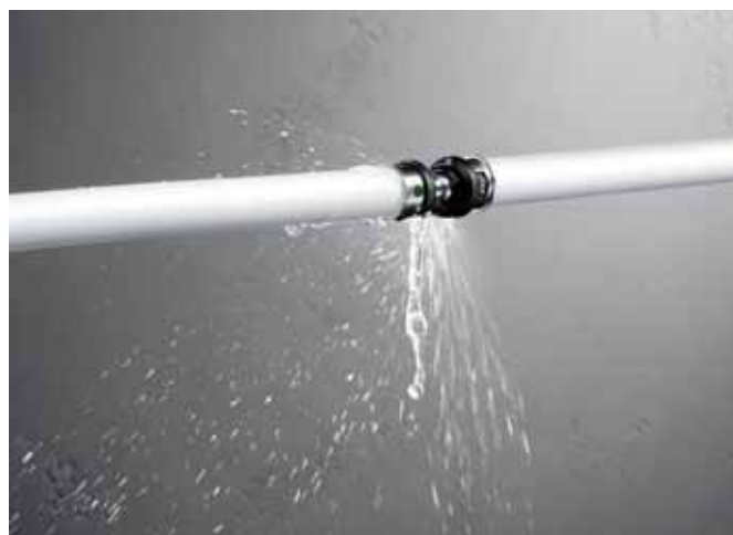
Spojky Viegasmartpress mají typickou SC-Contur, bezpečnostní prvek, který zajišťuje viditelnou netěsnost u omylem neslisovaného spoje
