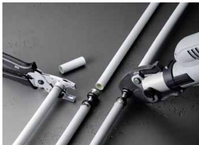
U Smartpress jsou nutné pouze tři pracovní kroky pro bezpečné trubkové spojení: zkrátit, zasunout až do průzoru a zalisovat; vše bez zdlouhavé kalibrace, odstraňování otřepů nebo tvarování trubky
