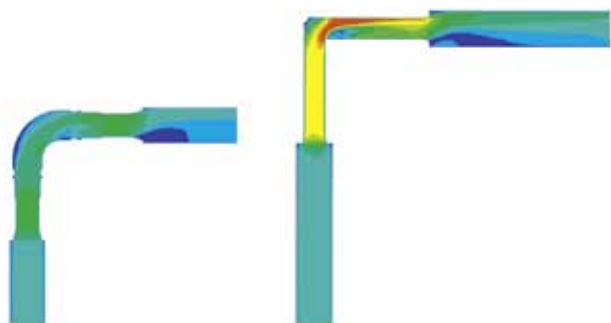
Grafika znázorňuje, jak proudově příznivé jsou spojky Viega Smartpress (vlevo) v porovnání s běžnou plastovou nebo mosaznou spojkou (Grafický obrázek: Viega)
