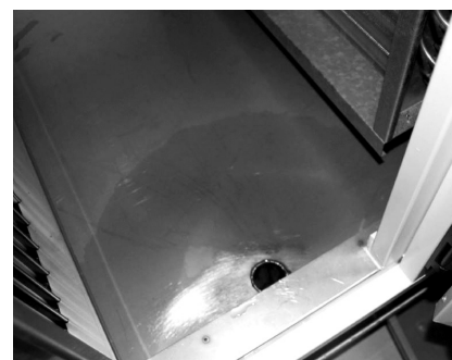
Obr. 3 Ukázka testování spádu dané vany na kondenzát
