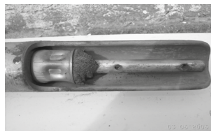
Obr. 4 Celkový pohled na uzavírací těleso DVA 2000 s viditelnými stopami po tepelném působení na pryžovou část tělesa, které je upálené těsně pod kovovou objímkou
