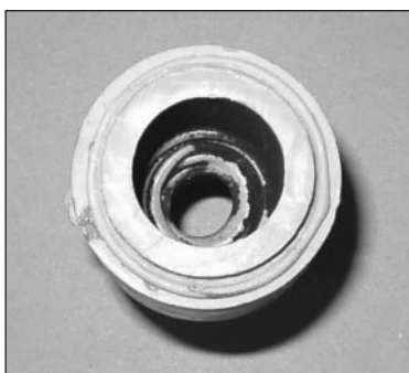
▲ Obr. 11 Návalky vzniklé špatně provedeným svarem
