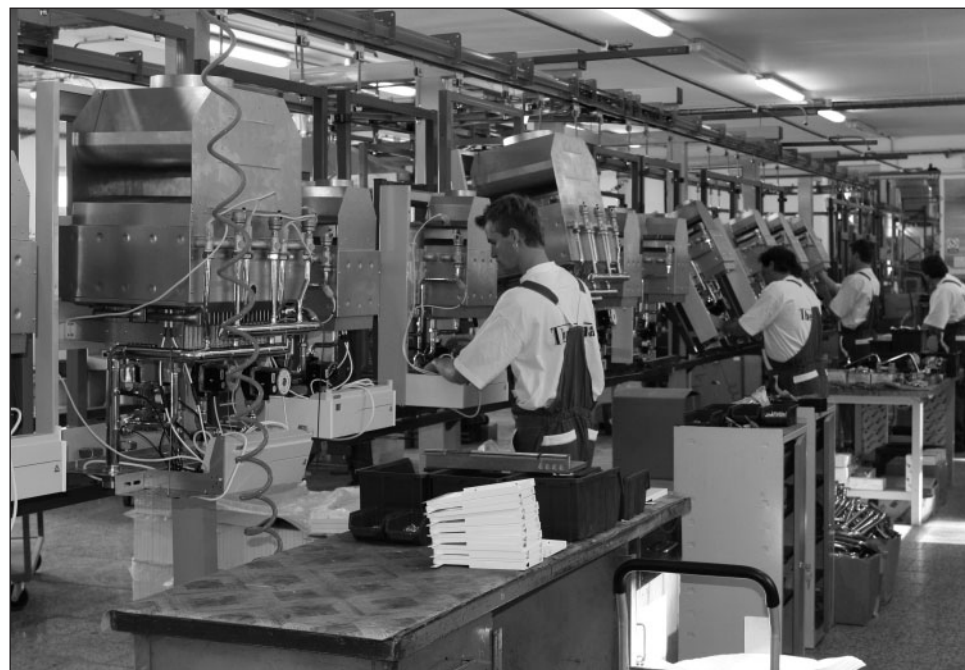
Montáž závěsných plynových kotlů ve výrobním závodě v Rapoticích.
