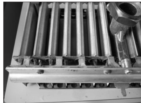
Obr. 8 Pohled na demontovaný hořák, kde je viditelné značné znečištění difuzorů pro přívod primárního vzduchu.
