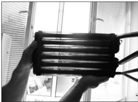
Obr. 13 Pohled proti světlu na výměník po vyčištění lamel výměníku.
