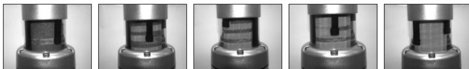
Ukázka čištění síta – patentovaný systém bodové rotace a odsávání síta.
