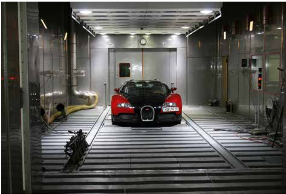
Obr. 2: Pojízdňé zařízení firmy Weiss Umwelttechnik pro simulaci podmínek a testování (automobil Bugatti)
