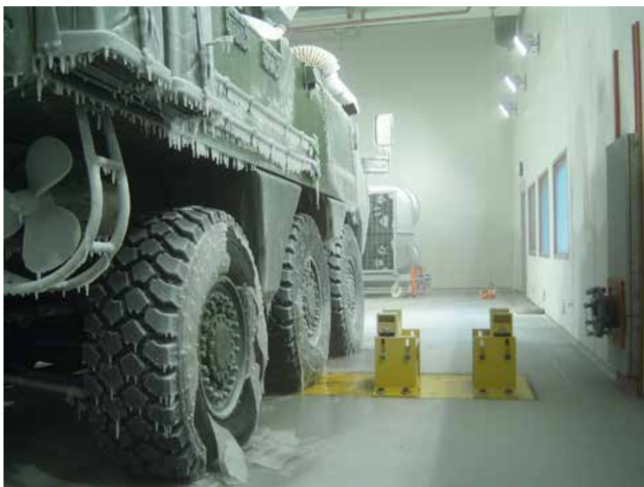
Obr. 1: Pojízdňé zařízení firmy Weiss Umwelttechnik pro simulaci podmínek a testování (armádní vozidlo)
