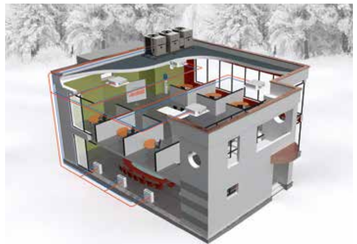
Příklad instalace a propojení plynového absorpčního tepelného čerpadla pro vytápění i chlazení (GAHP_Link_RTAR_uffici_sat)
