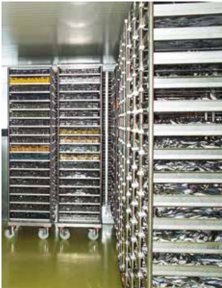
Zmrazovací tunel na paletové vozíky, jeden paletový vozík (Hordenwagen) pojme 54 přepravek a každá přeprava může pojmout 8,5 kg ryb
