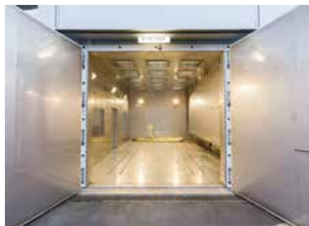
Obr. 5: Simulační komora firmy Weiss Umwelttechnik upravená na chladivo Opteon™ XP44 (R452A)
