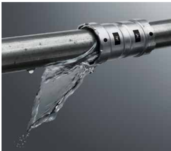
Také spojky „Megapress“ mají známou SC-Contur a jsou v neslisovaném stavu zjevně netěsné. Tak se objeví každé nedopatřením zapomenuté slisování již při první zkoušce těsnosti (Foto: Viega)
