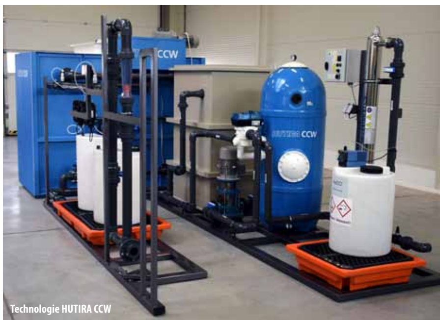
Kontejnerová úprava vody HUTIRA CCW, rozměry 6 050 × 2 435 × 2 435 mm, výkon 5 m 3 /h
