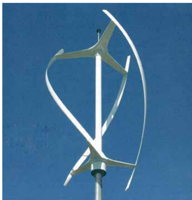
Obr. 6 Osa vertikálního rotoru probíhá svisle shora dolů
