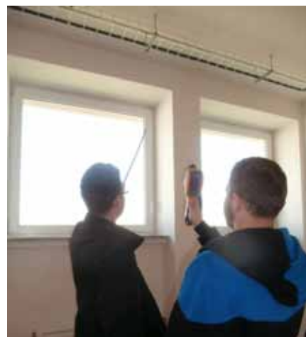
Obr. 3 Zjišťování úniku/šíření tepla termokamerou
