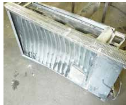
Obr. 1 Pohled na čelní stranu topidla Moratherm typ 731 s viditelným prohnutím do topidla v důsledku výbuchu
