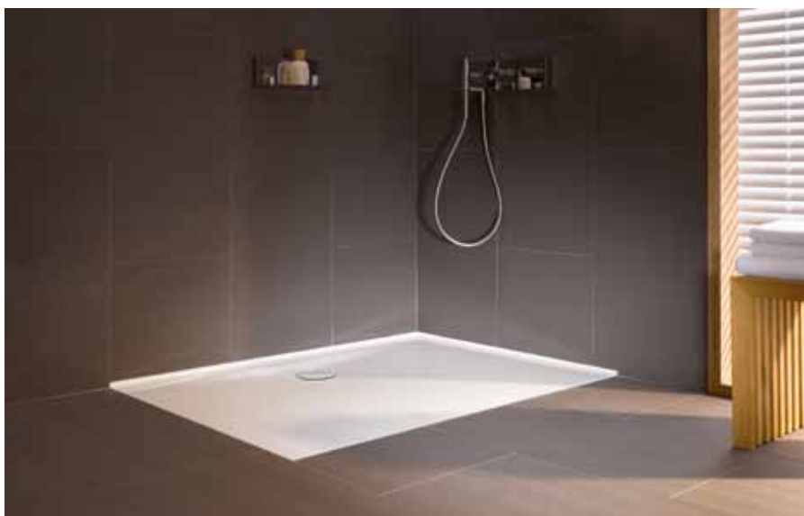
BetteFloor Side přináší bezspárovou instalaci u stěny: Namísto spádování vaničky směrem od stěny (jak bylo dosud obvyklé) spočívá řešení Bette v jednoduchém inteligentním bočním prvku, kterým je zdvižený lem o výšce 35 mm
