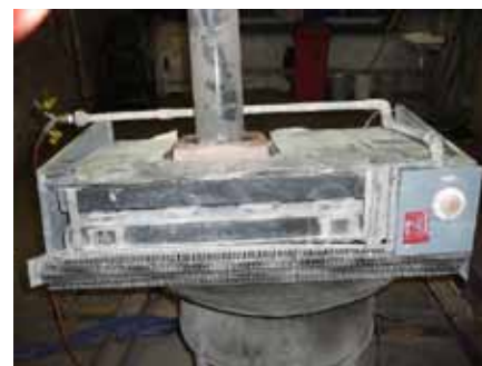
Obr. 2 Pohled na horní a zadní část topidla s připojenou hadicí pro kontrolu těsnosti
