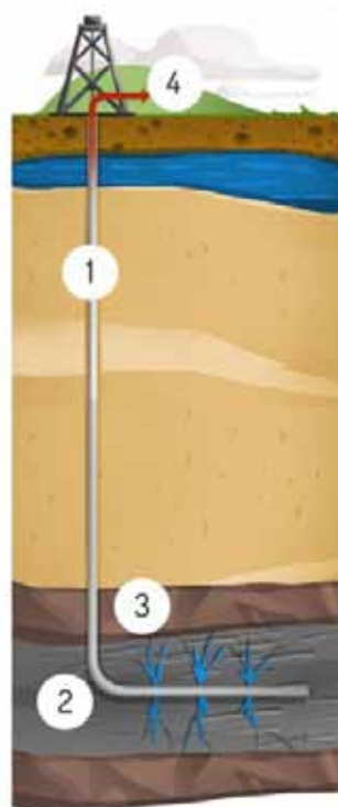
Obr. 4 Zjednodušené schematické znázornění procesu těžby břidlicového plynu
