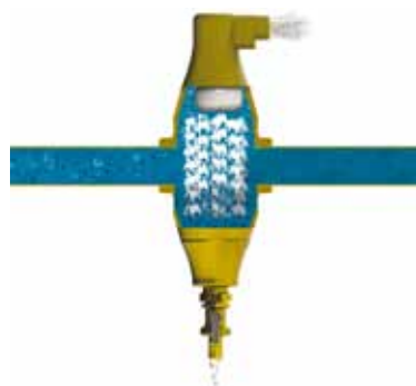
Armaturové těleso kombinovaného odvzdušňovače a odkalovače TacoVent Twin od společnosti Taconova obsahuje „kroužky I“, které z protékající topné vody oddělují nahoru vzduch a dolů nečistoty
