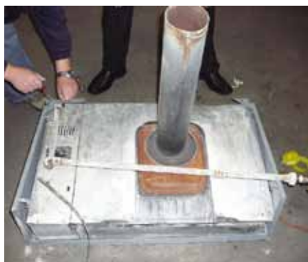
Obr. 4 Pohled na zadní část plynového topidla Moratherm typ 731 s připojením pro účely tlakové zkoušky těsnosti rozvodu plynu a zařízení topidla
