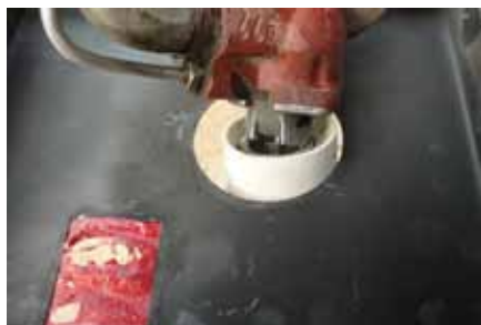
Obr. 3 Pohled na spodní část horního krytu, v popředí vlevo instalovaná páska zakrývající otvor po tlačítkách hlavního vypínače a vypínače proudu do žhavicí spirály, nahoře pohled na kohout s termoelektrickou pojistkou plamene
