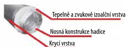
Obr. 2 Schéma zvukově izolační hadice
