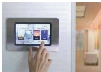
Obr. 6 Pohled do blízké budoucnosti: ovládání světla pomocí dotykového panelu nám dává mnoho možností (foto FGL)
