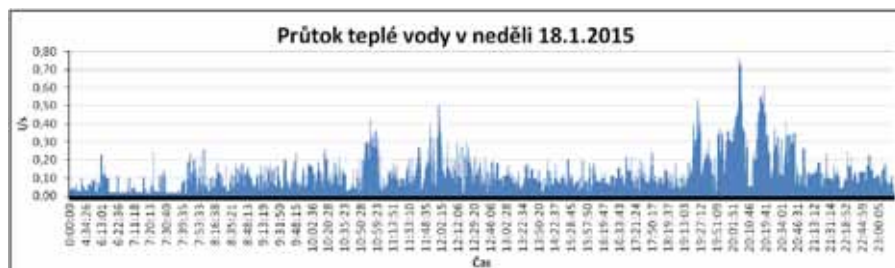
Obr. 4 Průtoky vody v bytovém domě v průběhu dne, kdy se vyskytl také největší průtok
