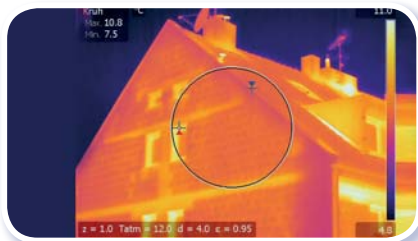
Obr. 2. Ukázka termovizního snímku budovy (světlé body označují úniky tepla)
