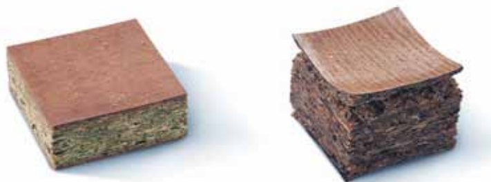
Materiál ošetřený proti působení vlhkosti (vlevo), materiál bez ošetření proti působení vlhkosti (vpravo)
