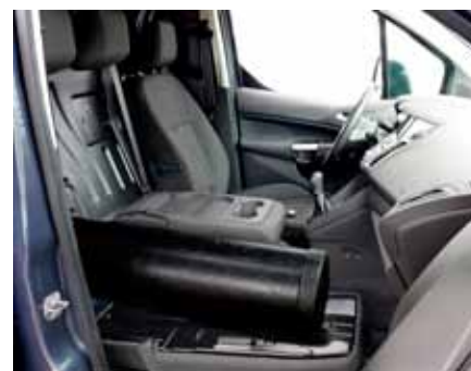
Díky průvzlaku v přepážce do vozu naložíte trubky, žebřík nebo jiný materiál o délce až 3,4 m.
