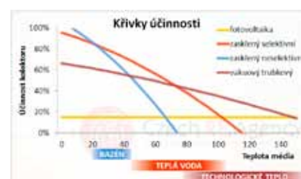
Obr. 4 Závislost účinnosti na teplotě média při teplotě okolí 25 °C a intenzitě záření 800 W/m 2
