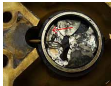
Obr. 2 Senzor průtokoměru zničený vniknutím páry a působením vysokého tlaku
