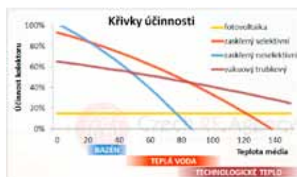
Obr. 1 Závislost účinnosti na teplotě média při standardních podmínkách pro testování fotovoltaických panelů (teplota okolí 25 °C, intenzita záření 1000 W/m 2 )
