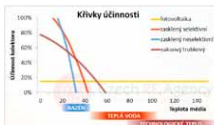
Obr. 5 Závislost účinnosti na teplotě média při teplotě okolí 20 °C a intenzitě záření 200 W/m 2
