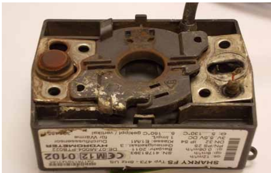
Obr. 1 Elektronická část ultrazvukového průtokoměru zcela destruovaná vniknutím páry
