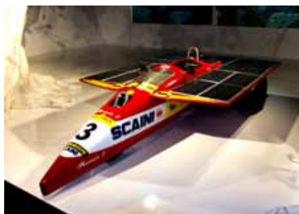
PHOENIX – automobil na solární pohon, dojezd 50 km, max. rychlost 80 km/h, hmotnost 179 kg
