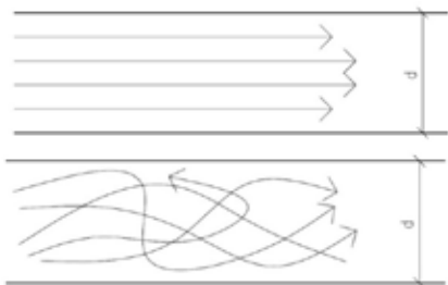
Obr. 4 Proudění tekutiny v ohraničeném prostoru o poloměru d [m]; nahoře – laminární proudění ( Re < 2300 ), dole – turbulentní proudění ( Re >> 2300 )
