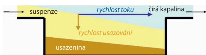
Obr. 2. Rozhraní vrstev při kontinuálním vzniku usazenin [1]
