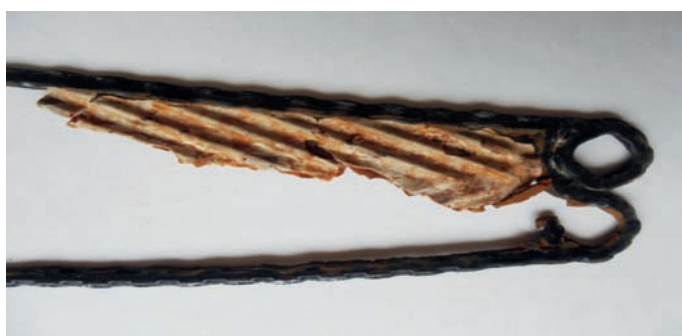
Obr. 5. Část usazeniny do výšky těsnění teplosměnné plochy energetického aparátu
