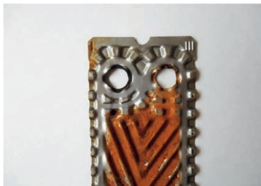
Obr. 4. Detail usazeniny na teplosměnné ploše energetického aparátu
