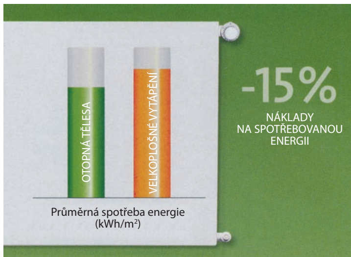
Studie vypracovaná na základě výzkumných prací „in situ“ (Dr. Ch. Harryson, Švédsko) udává, že u dobře tepelně izolovaných budov vykazují moderní otopné soustavy s otopnými tělesy energetickou účinností přibližně o 15 % nižší, než vychází u velkoplošných soustav.
