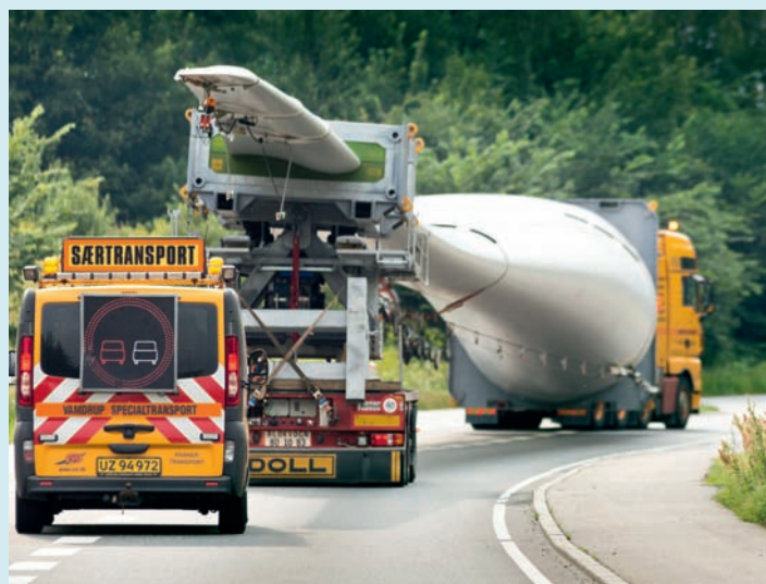
Obr. 3. Náročný transport lopatek do destinace vzdálené 320 km od místa výroby si vyžádal odstranění šesti pouličních lamp a jedenácti dopravních značek
