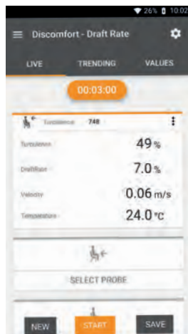
Obr. 8: Zde je možné sledovat naměřenou střední rychlost proudění vzduchu, průměrnou teplotu vzduchu, z nich vypočítaný stupeň turbulence a obtěžování průvanem. V příkladu máme stupeň obtěžování průvanem 7 %.
