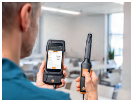
Obr. 2: Měření teploty a vlhkosti okolního vzduchu pomocí měřicího přístroje testo 400 pro měření klimatických veličin.
