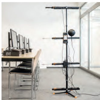
Obr. 7: Všechny výšky lze měřit s přístrojem testo 400.
