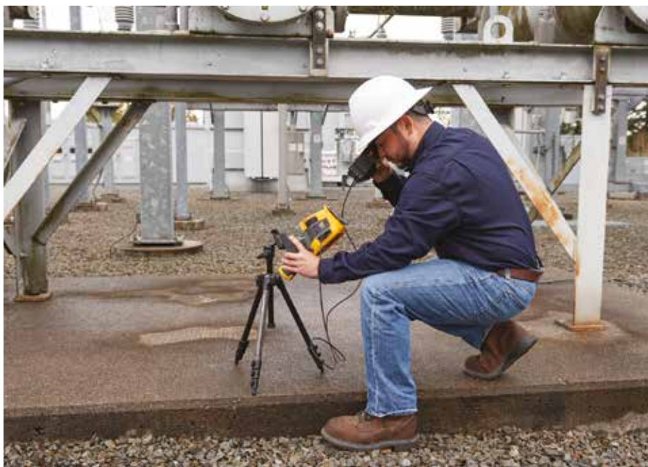
Obrázek 5: Použití stativu a digitálního okuláru při detekci plynu \text{SF}_6
