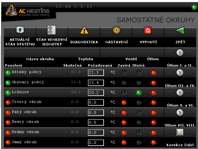
Obr. 13: Nastavení více topných okruhů
