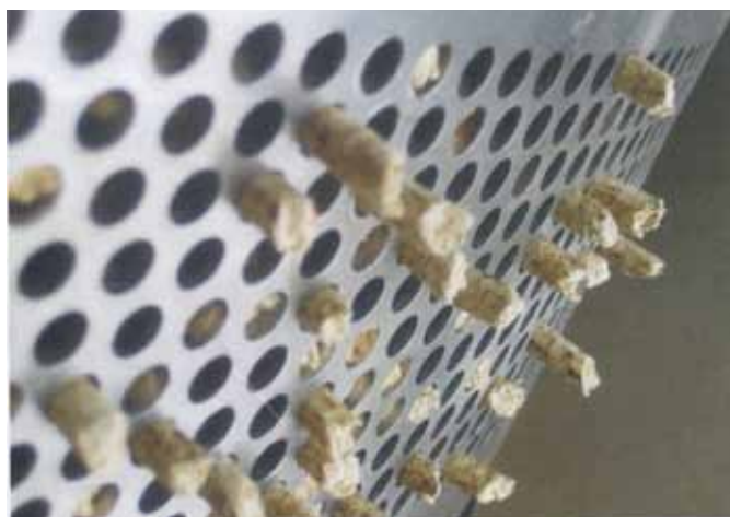
Obr. 2 Při výrobě dřevěných pelet jsou nejprve připraveny dřevěné třísky, které jsou následně vysokým tlakem protlačovány skrz ocelovou matici s otvory. Dochází zde ke zvýšení teploty, při níž se zkapalňuje lignin obsažený ve dřevu, který tak plní funkci spojovacího prostředku. Lisovací proces zvyšuje možnost vzniku emisí CO u pelet v porovnání s použitými dřevěnými třískami
