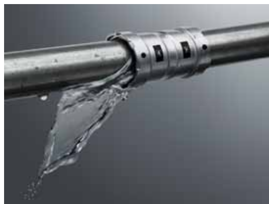
Také spojky „Megapress“ mají známou SC-Contur a jsou v neslisovaném stavu zjevně netěsné. Tak se objeví každé nedopatřením zapomenuté slisování již při první zkoušce těsnosti
