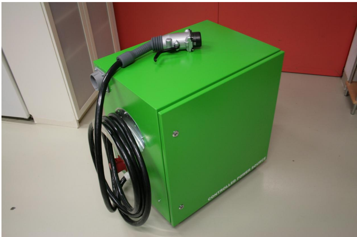
Obr.2. Prototypová realizace nabíjecí/vybíjecí jednotky RD v Prototypové laboratoři CPIT VŠB-TUO.
