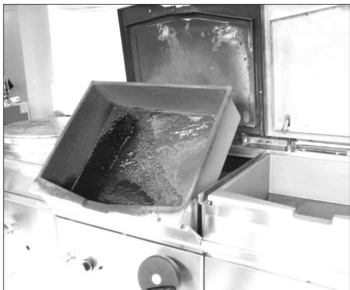
Obr. 2 - Celkový pohled na vykloněnou pánev, na dně pánve patrné zbytky po spáleném oleji.
