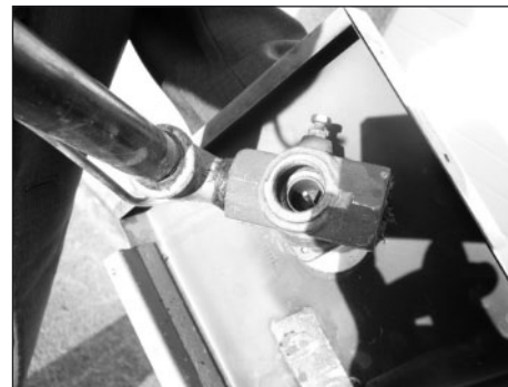
Obr. 7 Pohled do spodní části kohoutu s termoelektrickou pojistkou, kde došlo k demontáži.
