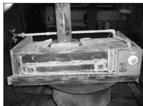
Obr. 2 Pohled na horní a zadní část topidla s připojenou hadicí pro kontrolu těsnosti.
