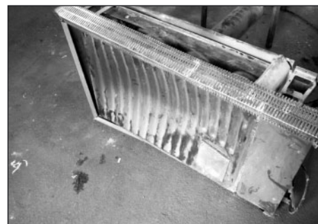
Obr. 1 Pohled na čelní stranu topidla Moratherm typ 731 s viditelným prohnutím do topidla v důsledku výbuchu.
