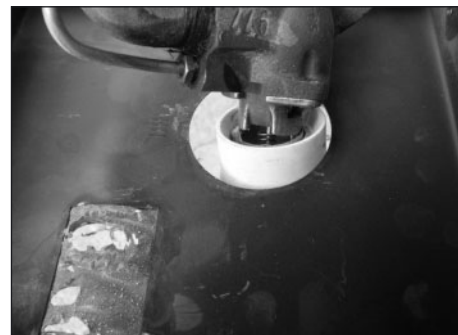
Obr. 3 Pohled na spodní část horního krytu, v popředí vlevo instalovaná páska zakrývající otvor po tlačítkách hlavního vypínače a vypínače proudu do žhavicí spirály, nahoře pohled na kohout s termoelektrickou pojistkou plamene.
